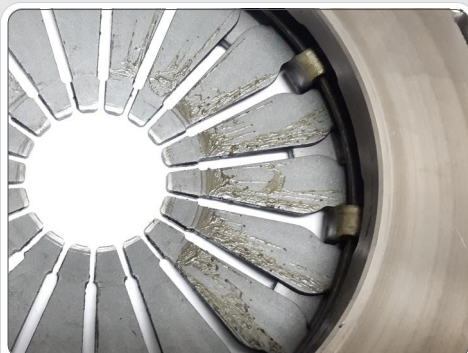
Conjunto Contaminado Lubrificante
