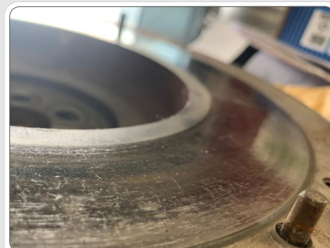
Volante Motor Vitrificado
