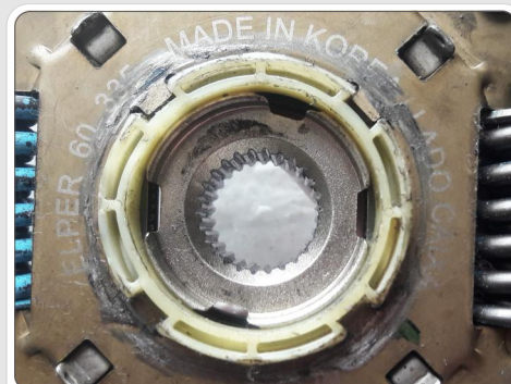
Disco Montado Invertido
