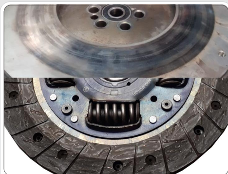
Volante Motor Empenado
